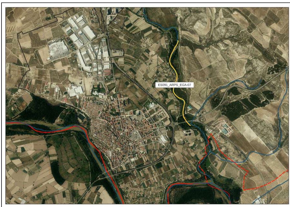
Figura 4. Tramo ARPSI que afecta al término municipal de San Adrián. En el término de San Adrián, únicamente el río Ega, en su tramo marcado en color naranja, ha sido catalogado por la Confederación Hidrográfica del Ebro como tramo ARPSI. El Ebro a su paso por San Adrián, no se definió como de Riesgo Potencial Significativo de Inundación.
